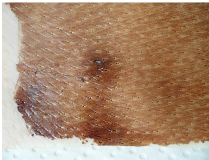
Obr. 5.1 Vepřová kůže znečištěná magnetickou kapalinou
