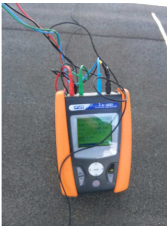
Obr. 4.1: Přístroj na měření V-A charakteristik FV panelů. [zdroj vlastní]
