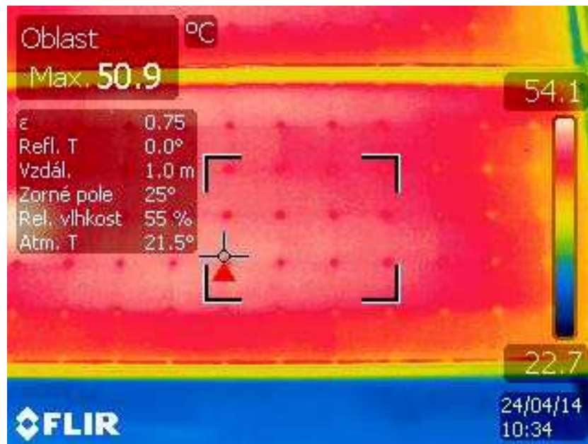
Obr. 4.6: Detailní náhled na FV článek termokamerou. [14]
