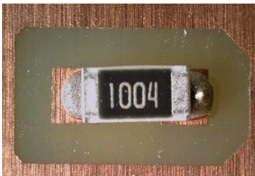
Obr. 2.2: Detail testovacího vzorku osazeného rezistorem před pájením
