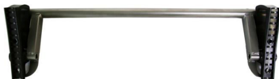
Obr. 2.2: Konstrukce odpružení s pryžovou vložkou, firma Burley.
