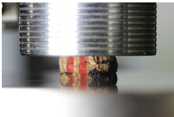
Obrázek 4.9: Tlakový vzorek po zatížení (25% nominální deformace)
