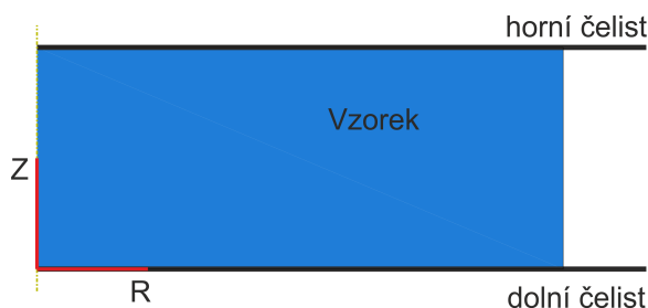
Obrázek 5.5: Geometrie a okrajové podmínky tlakového modelu
