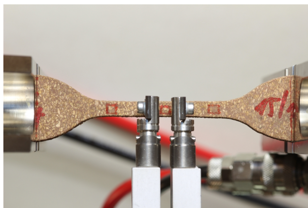
Obrázek 4.4: Tahový vzorek po zatížení (25% nominální deformace)
