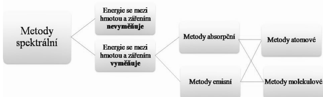
Obr. 1 Schematické rozdělení spektrálních metod
