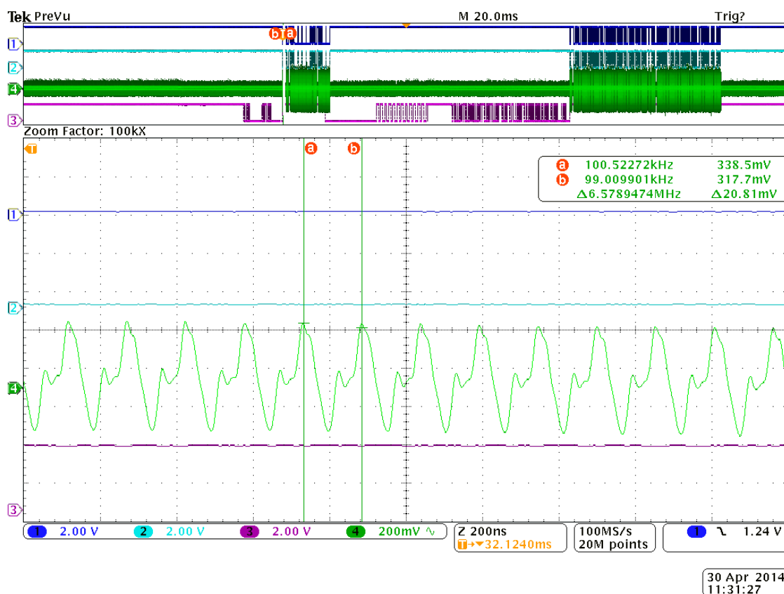
Obr. 24 Průběh modulovaného signálu na napětí baterií
