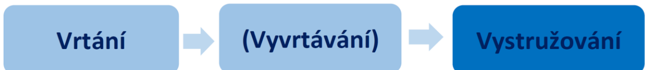
Obr. 1 Nejčastěji používaný technologický postup pro dokončování velmi přesných děr.
