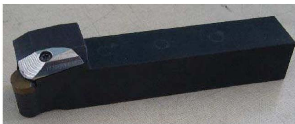
Obr. 1 Soustružnický nůž Fig. 1 Turning tool
