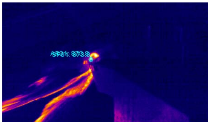
Obr. 6 Termogram při v_c=150 m/min, f=0,15 mm/ot Fig. 6 Thermograph at v_c=150 m/min, f=0,15 mm/ot
