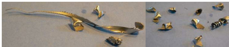
Obr. 4 Tvar třísek (zleva E, A)
