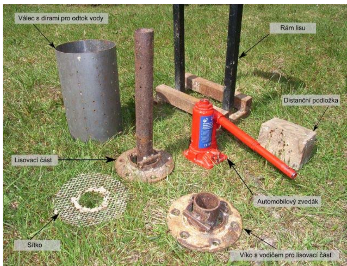
Obrázek 1: Součásti lisu
