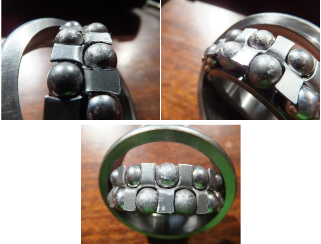
7.5: Uměle poškozené ložisko L2
