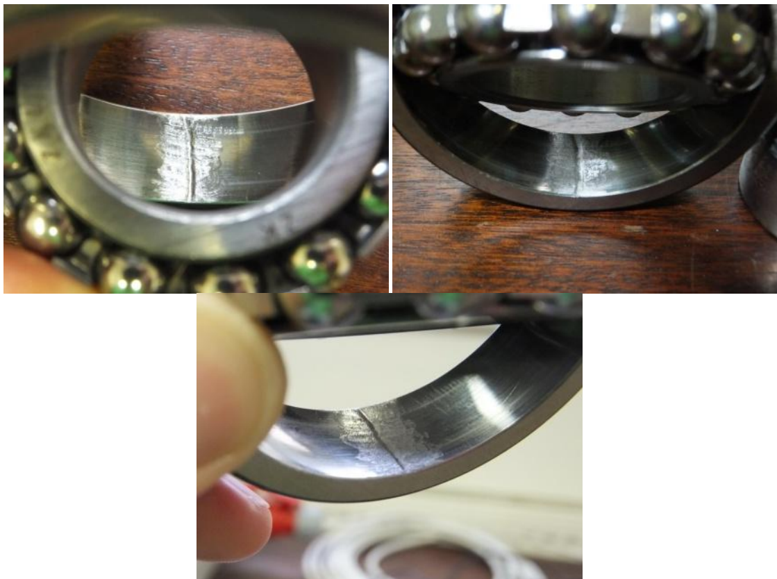
7.4: Uměle poškozené ložisko L1
