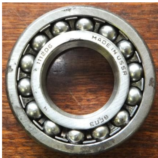
7.2: Poškozené ložisko 8ГЛ3 111206
