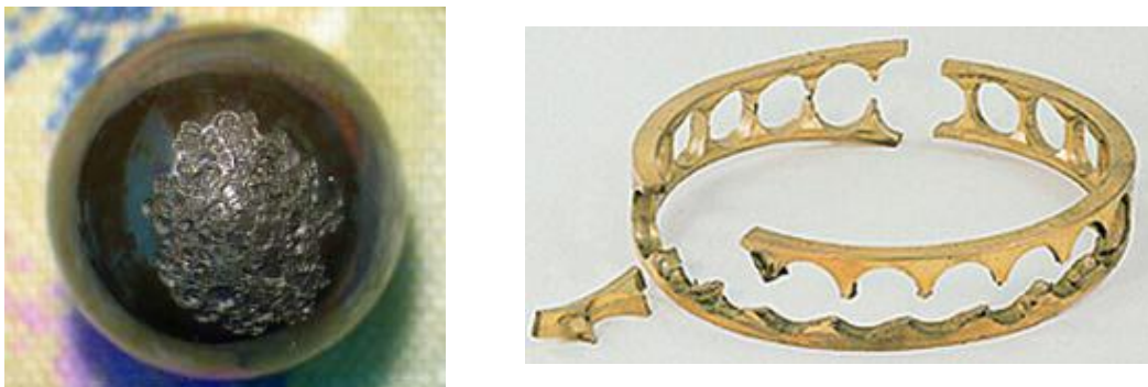
3.13: Poškození valivé kuličky a poškození klece ložiska
