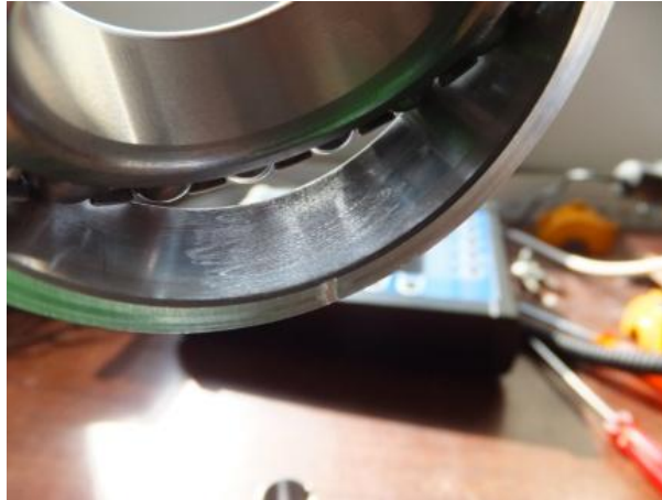
7.3: Uměle poškozené ložisko L0
