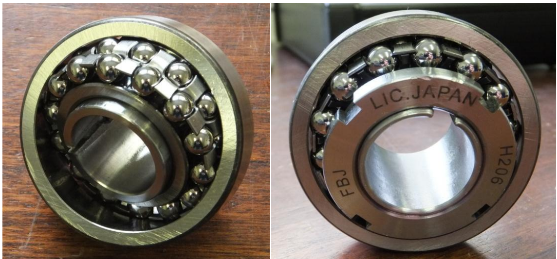
7.1: Nové ložisko ZKL 1206 K
