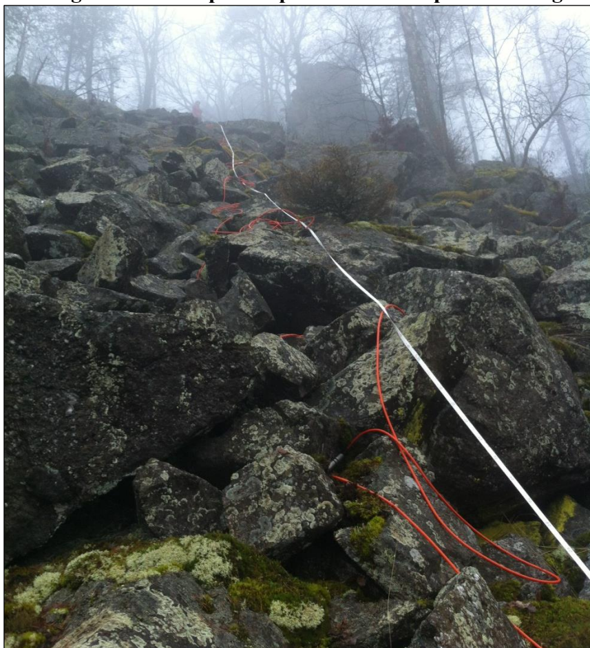
Příloha 3: Fotografie. Vedení profilu při elektrické odporové tomografii (ERT)
