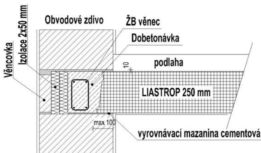
Obrázek 55: Detail způsobu uložení SPIROLLU
