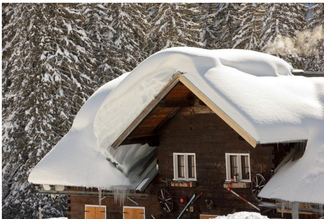
Obrázek 21: Vliv působení větru na rozmístění sněhové pokrývky
