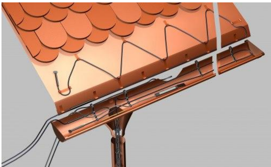
Obrázek 25: Možné umístění odporových topných kabelů
