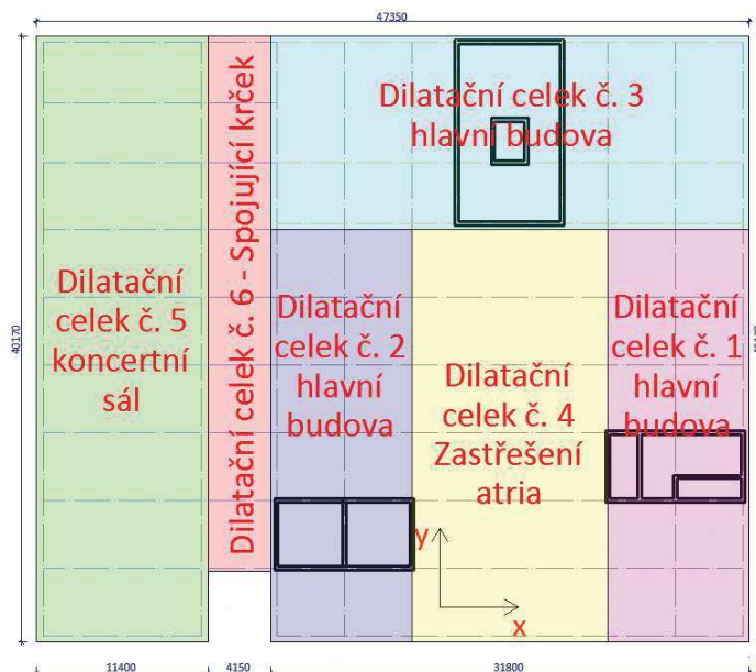
Obr. 4 Rozdělení objektu na dilatační celky
