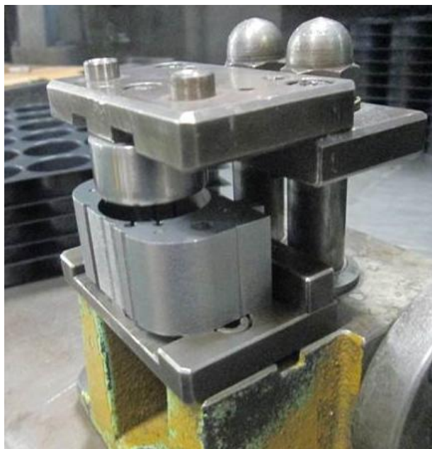
Obrázek 10 - Přípravek pro vystředění a správnou polohu při vrtání statoru (Poka yoke)
