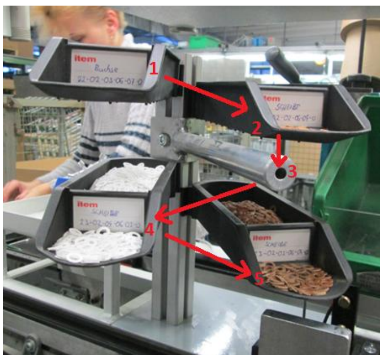
Obrázek 21 - Postup navlékání vrchní strany rotoru po zavedení do linky (Poka yoke, 5S, LEAN)
