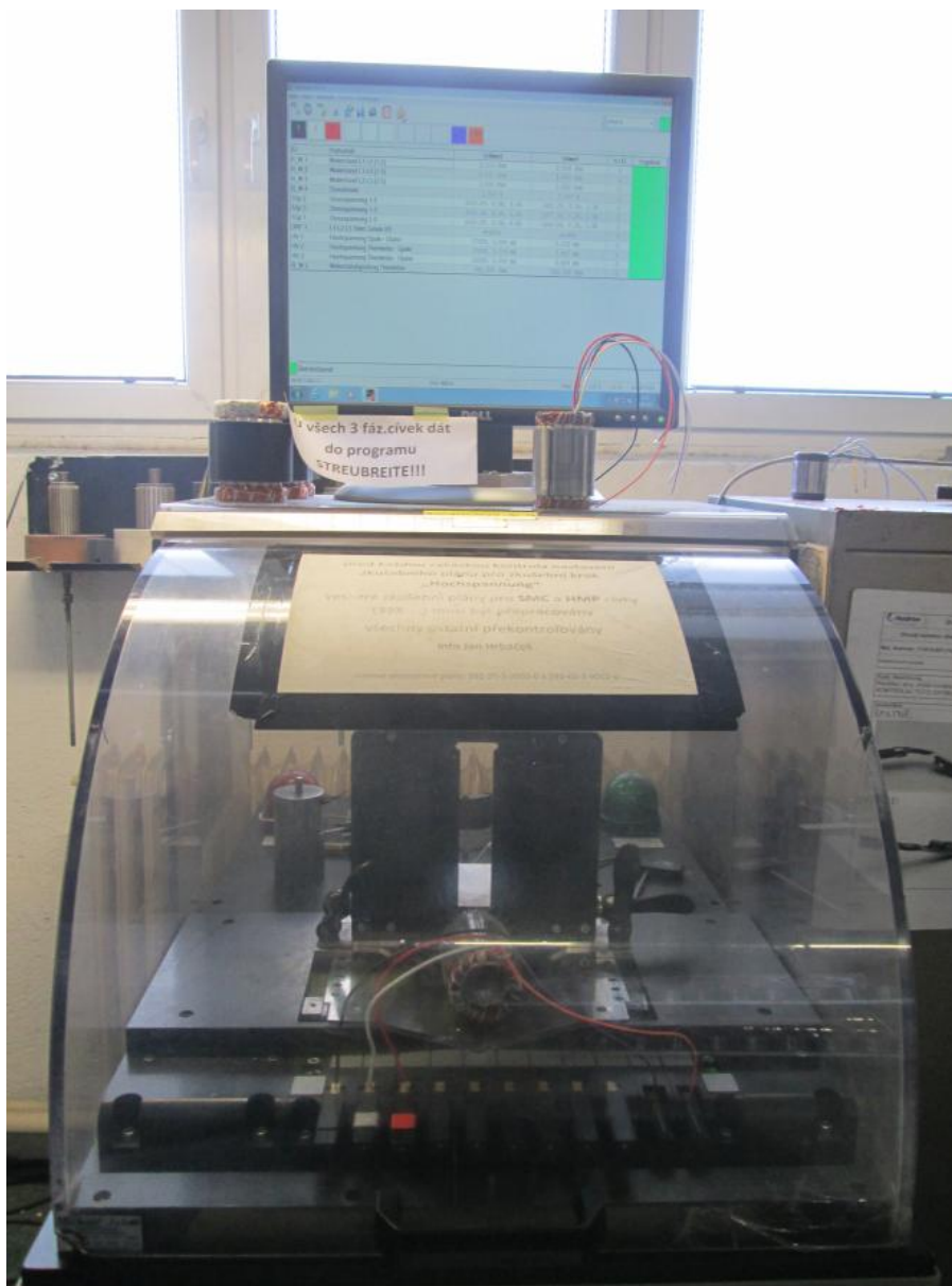
Obrázek 12 - Zkoušečka cívek (Poka yoke)
