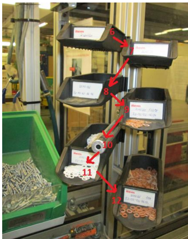
Obrázek 22 - Postup navlékání spodní strany rotoru po zavedení do linky (Poka yoke, 5S, LEAN)
