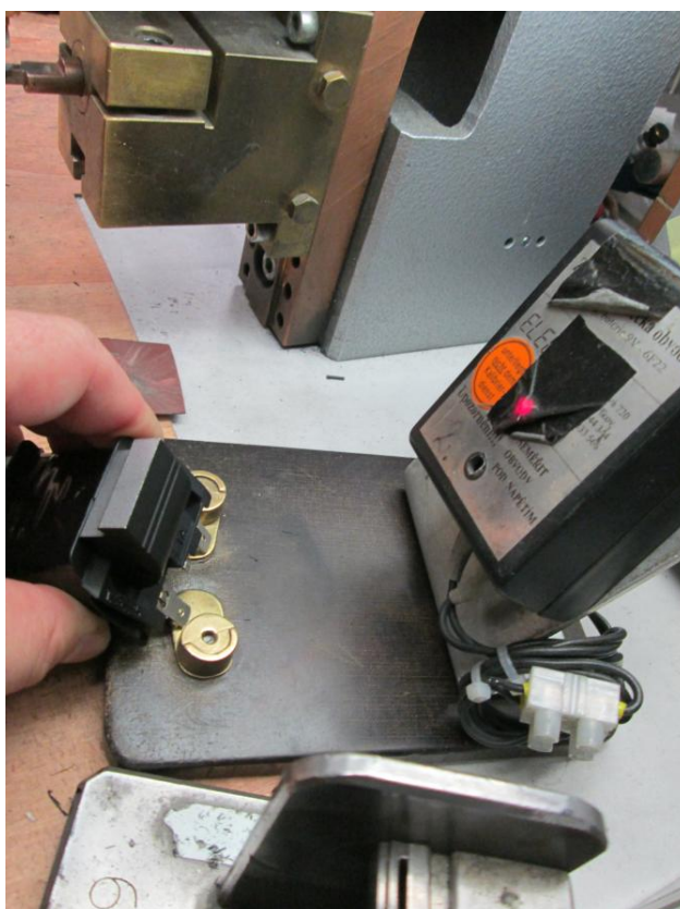
Obrázek 11 - Zkoušečka spojení sváru - zvukový + vizuální hlásič (Poka yoke)
