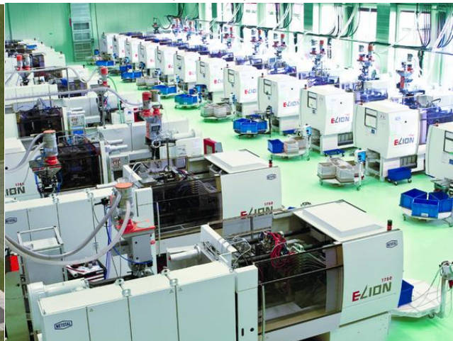
Obr. č. 2: Vstřikovací lisy v nové výrobní hale
