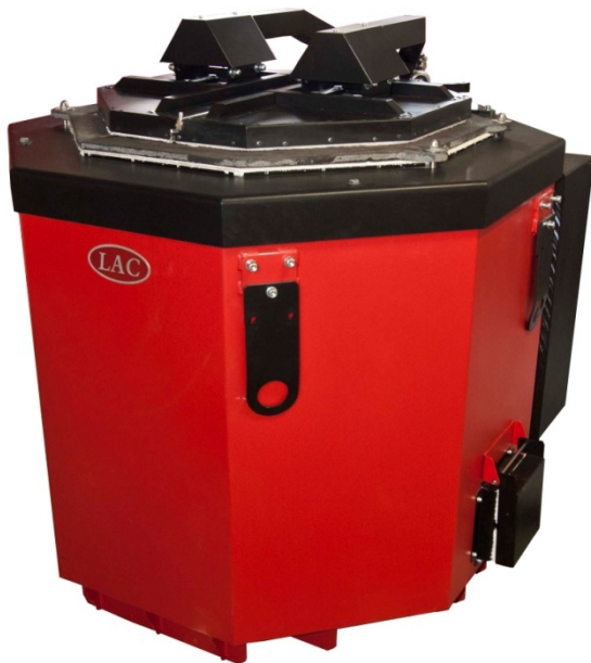
Obrázek 28: Udržovací pec LAC
