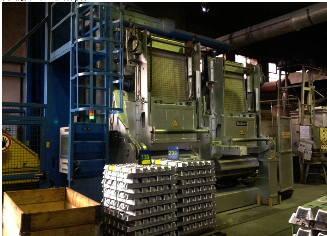
Obrázek 20: Tavicí pec BALZER II
