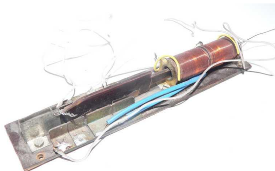
Obr.5: Elektromagnetický přestavník s táhlem uvnitř cívky
