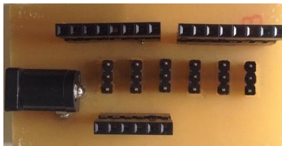
Obr 2.6: Deska plošných spojů pro připojení napájení, Arduina a servomotorů
