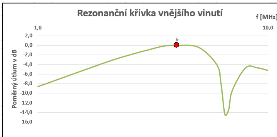
Obrázek 24 Změřená rezonanční křivka vnějšího vinutí transformátoru, bod f_r odpovídá rezonančnímu kmitočtu, tj. 0 dB
