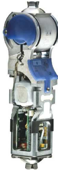
Obr. 1.5 Náhrada kolenního kloubu pomocí MR kapaliny; Ossur Inc., 2011 (převzato z [9])
