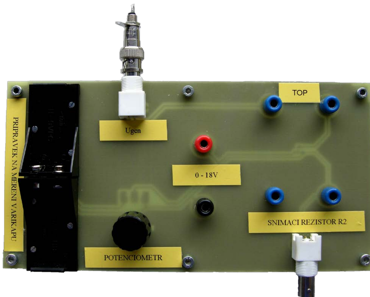
Obr. 5.2 Základní přípravek pro Ohmovu a rezonanční metodu.
