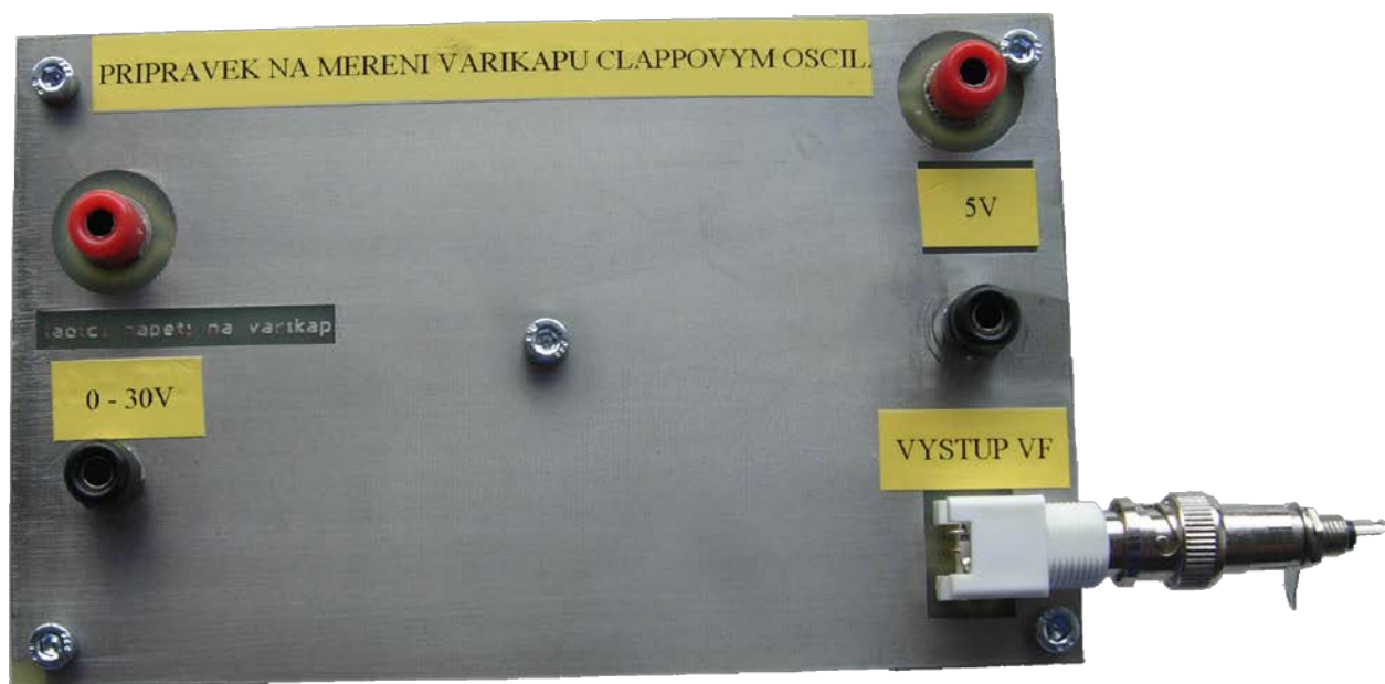
Obr 5.4 Přípravek na měření varikapů Clappovým oscilátorem.
