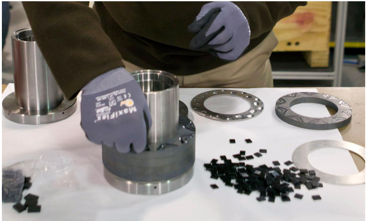
Obr. 4.3 Ruční montáž vnitřních PM Převzato z [19]
