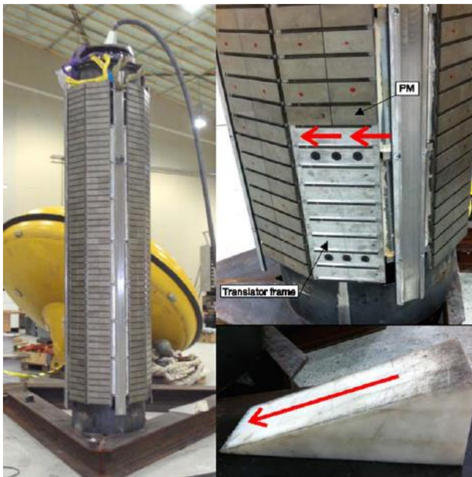
Obr. 4.10 Experimentální náhrada za velký rotor osazený PM Převzato z [21]
