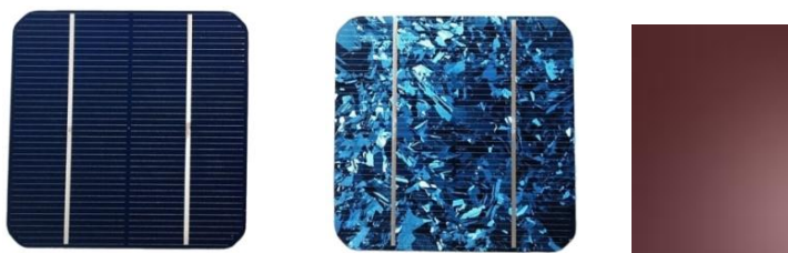
Obr. 1: Monokrystalický, Polykrystalický a amorfni článek[8]
