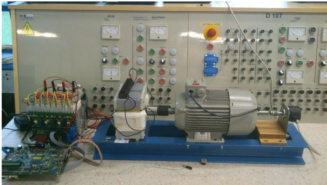
Obr. 4.5 Sestava pro měření FSPM stroje s větším rotorem jako motoru
