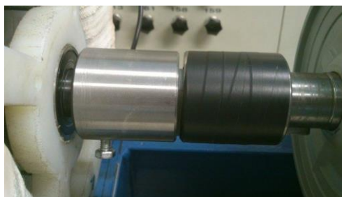
Obr. 3.9 Detail spojení hřídelí FSPM a asynchronního stroje - větší rotor
