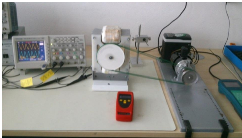
Obr. 3.5 Sestava pro měření na FSPM generátoru - menší rotor
