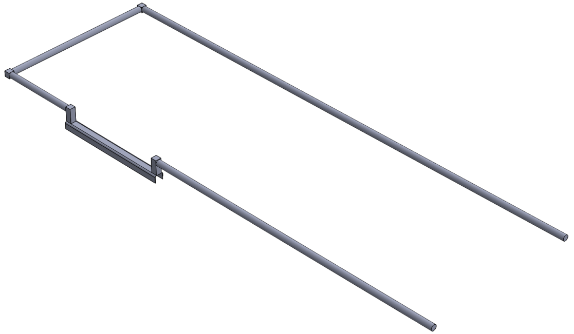
Obrázek 3.10 – Model zjednodušeného odpojovače a proudové smyčky
