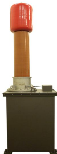
Obr. 28: Bezvýbojový vysokonapětový zdroj zkušebního napětí [7]
