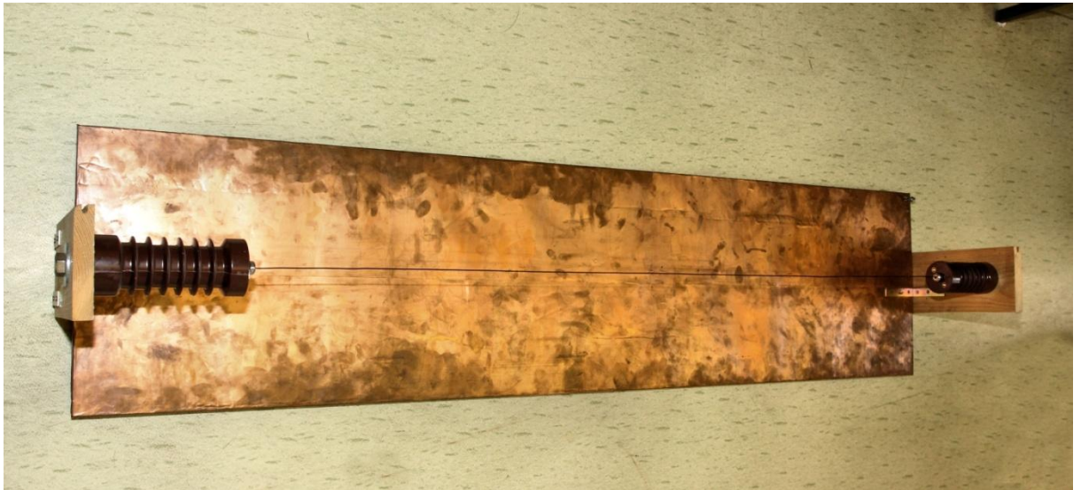
Obr. 11: Foto zkoušeň vodič-zem
