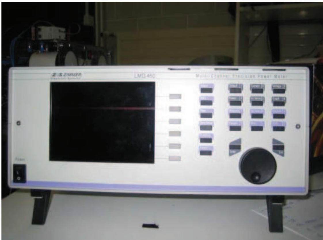
Obr. 30 - Vícefázový analyzátor výkonu ZES ZIMMER LMG 450 [10]
