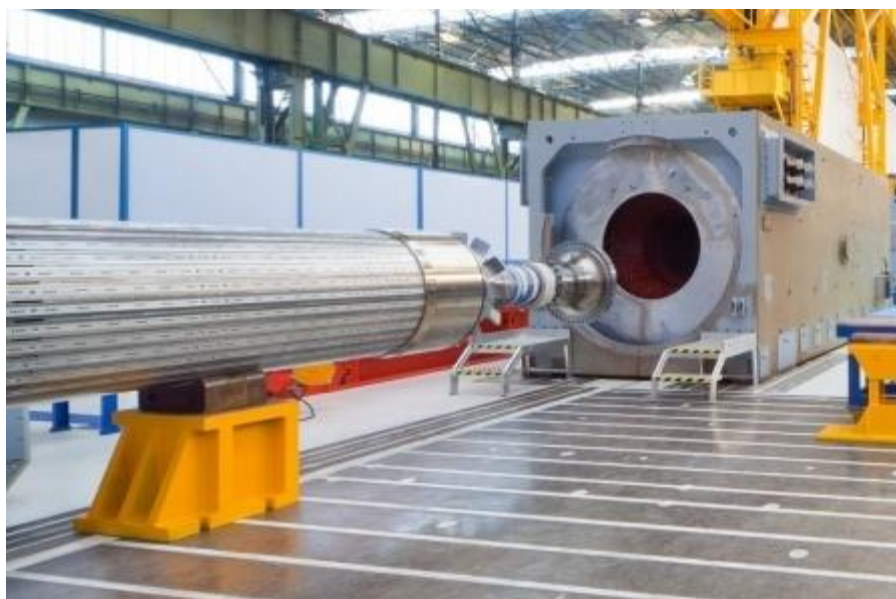
Obr. 3 Příprava vložení rotoru do statoru [3]
