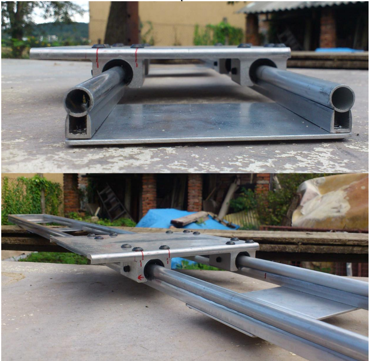
Obr. 1A – Zhotovené kolejiště s ložiskovým vozíkem
