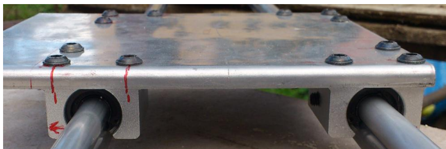
Obr. 5 – Vlastní konstrukce vozíku, ukázka ložiska (převzato z [10])
