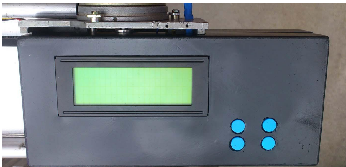
Obr. 12 – Krabička se zabudovanou zobrazovací jednotkou a klávesnicí
