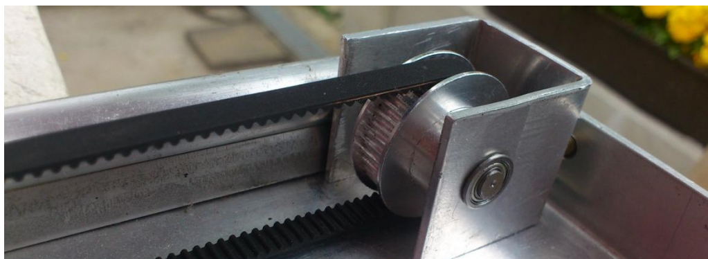
Obr. 9 – Volnoběžná řemenice usazená v ložiskách, s možností regulací prnutí řemene
