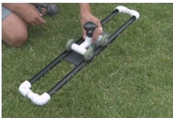
Obr. 2 – Vozík se silikonovými kolečky určen na hladký povrch, nebo využijeme kolejnic (převzato z [2, 3])
