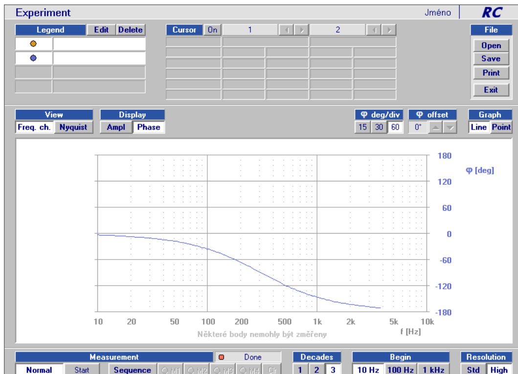
Obrázek 28: Naměřená přenosová frekvenční charakteristika DP 2. řádu
