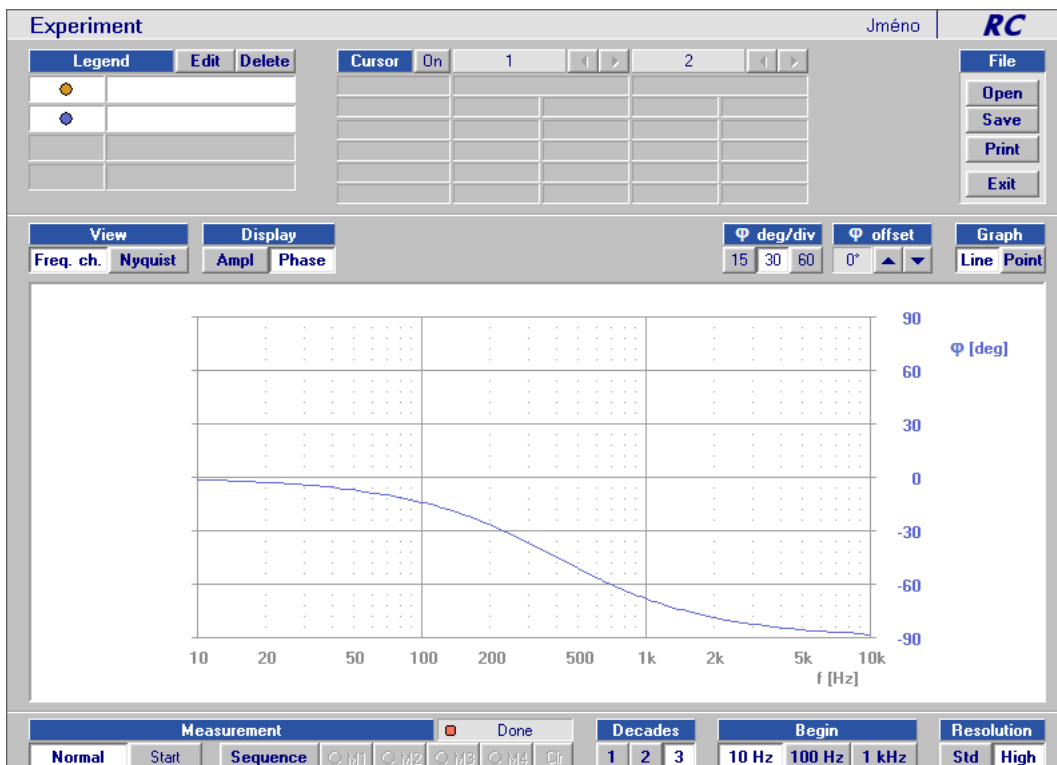
Obrázek 24: Naměřená přenosová frekvenční charakteristika DP 1. řádu
