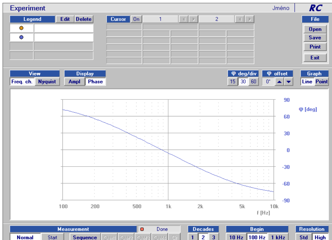
Obrázek 32: Naměřená přenosová frekvenční charakteristika PP 2. řádu
