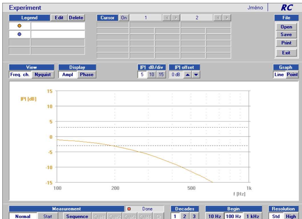
Obrázek 28: Naměřená přenosová frekvenční charakteristika DP 2. řádu
