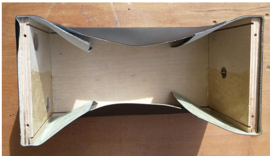
Obr. 29 Aplikace koženky na nosnou konstrukci
