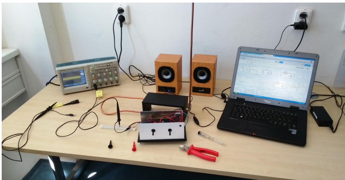
Obr. 23 Měření odezvy antén v závislosti na vzdálenosti
