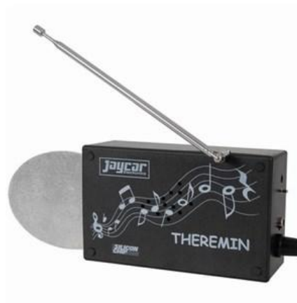
Obr. 16 Theremin Synthesiser Kit MkII využívající prutovou i deskovou anténu (převzato z [16])
