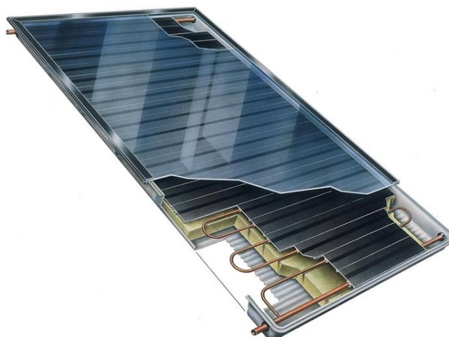
Obr. 2.3 Řez plochým kolektorem [11]
