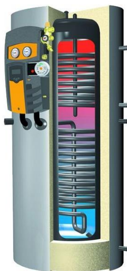
Obr. 2.5 Solární zásobník s dvěma výměníky [14]
