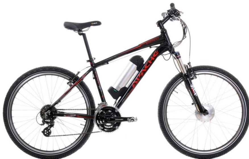
Obr. 13 Příklad konstrukce horského elektrokola s motorem umístěným ve středu předního kola [23]
