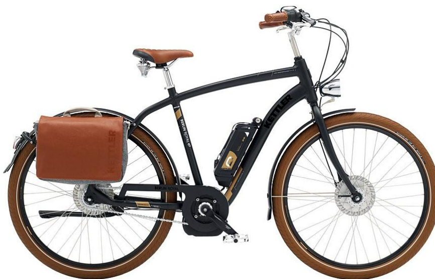
Obr. 12 Příklad konstrukce městského elektrokola s motorem ve středové ose pedálů [22]
