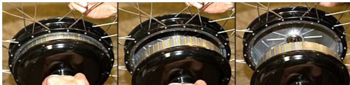
Obr. 17 Stator BLDC motoru s elektromagnety zasazený do rotoru s permanentními magnety [25]
