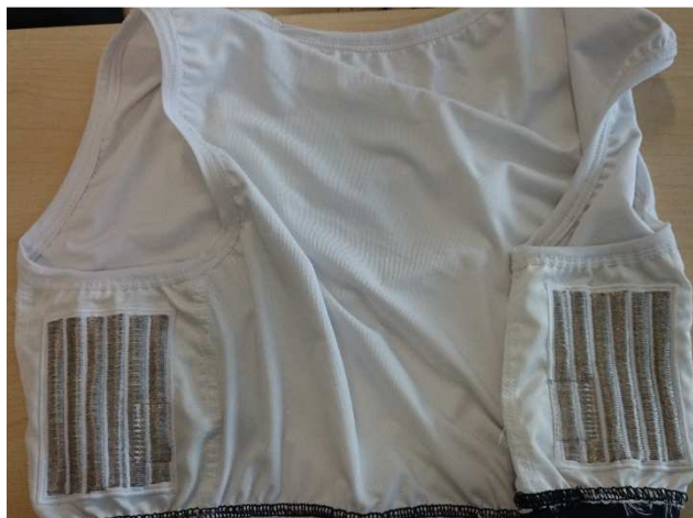
Obr. 5.13: Měřicí oděv se dvěma elektrodami
