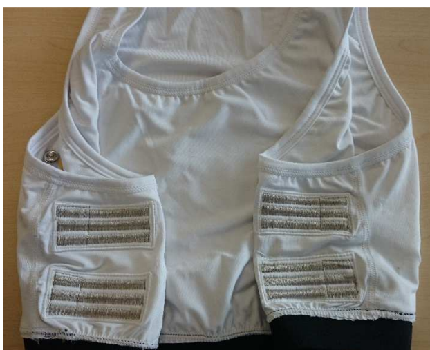
Obr. 5.14: Měřicí oděv se čtyřmi elektrodami
