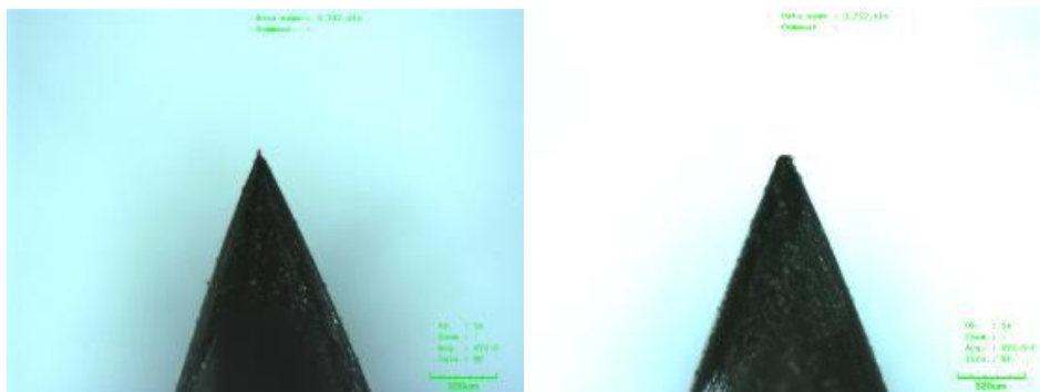
Obr. 2.1. Hrot jehly před a po namáhání vysokým napětím [7]
