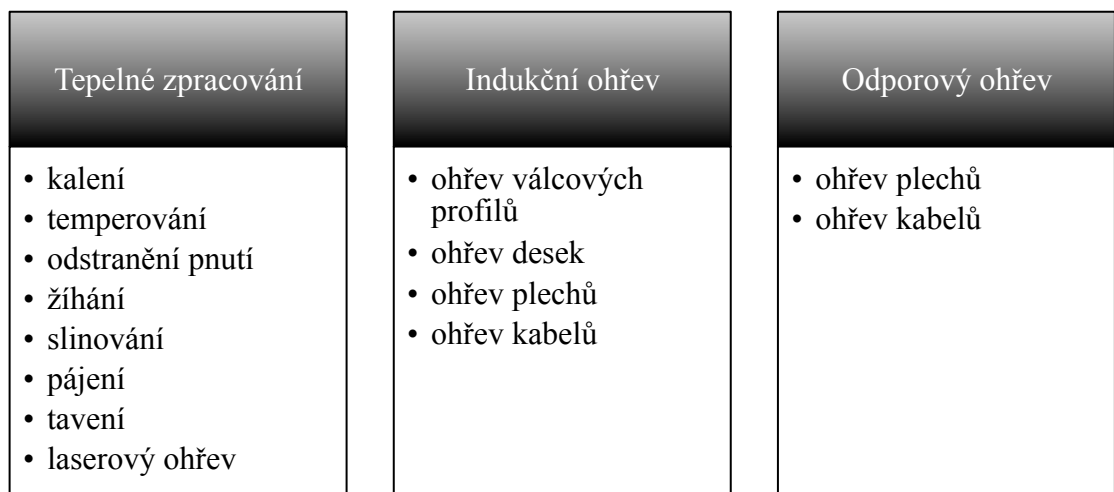
Obr. 2.3 Průmyslové aplikace tepelného zpracování kovů, překresleno z[10]
