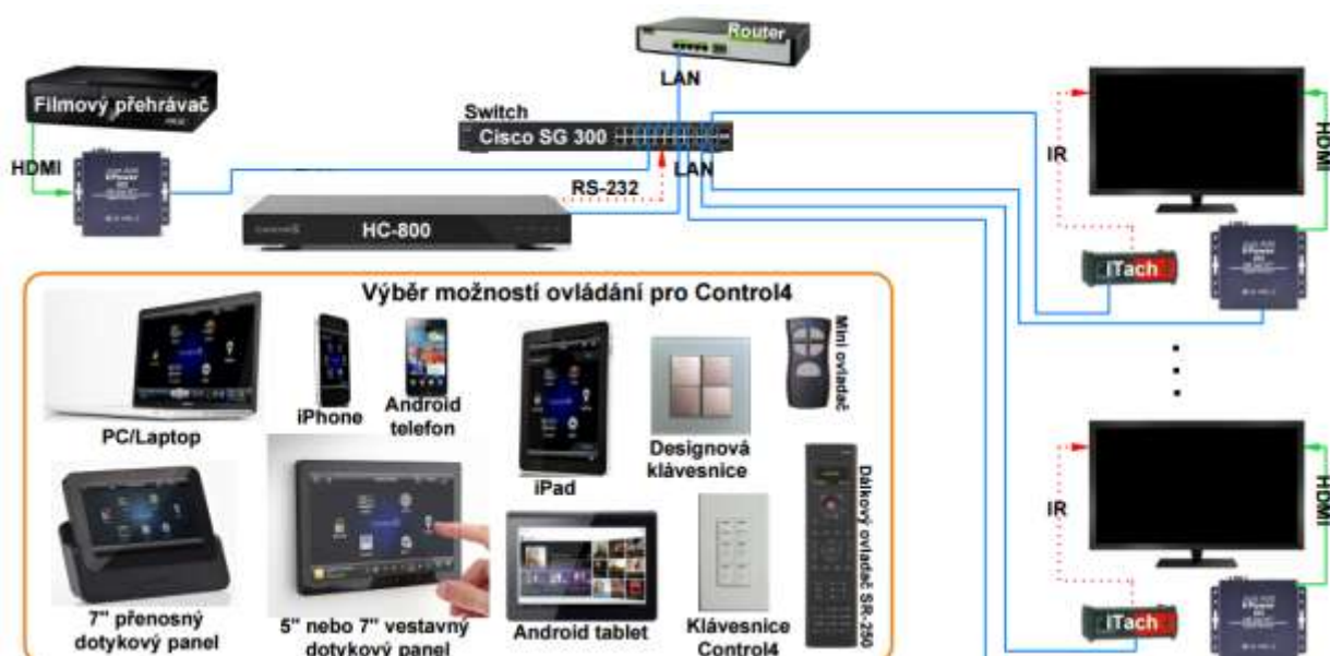
Obr.5.1 Schéma distribuce obrazu přes IP [8]
