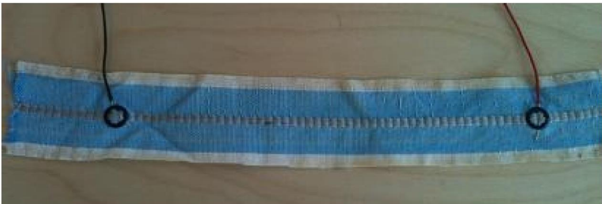
Obr. 6: Vetkaný vodič do textilie (převzato z [19]).
