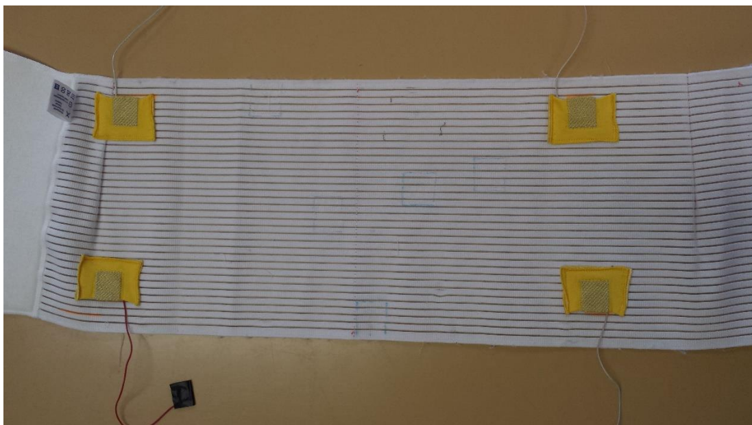
Obr. 15: Hrudní pás s integrovanými textilními elektrodami pro laboratorní měření dechové frekvence.
