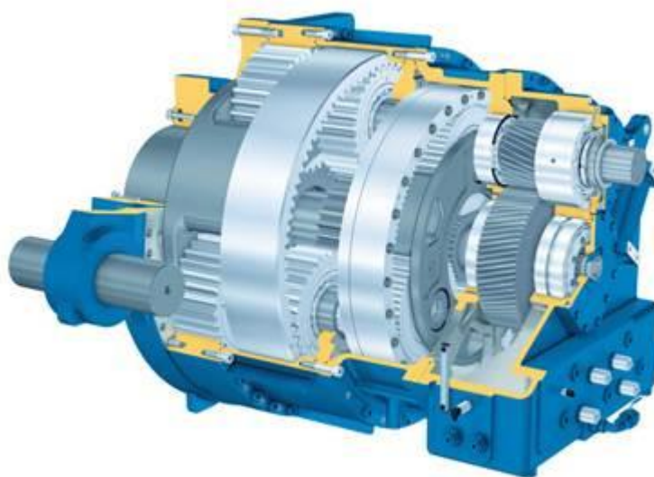
Obr. 2.9 Dvoustupňová planetová převodovka Redulus GPV pro výkon 2MW od firmy Bosch Rexroths výstupním koaxiálním stupněm [2]
