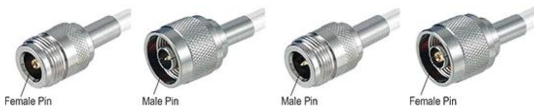
Obr. 2.2: Konektor typu N (v pořadí zleva: N-FEMALE, N-MALE, RP-N-FEMALE, RP-N-MALE) [24]
