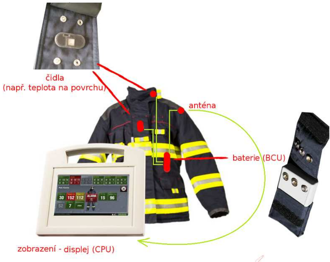
Obr. 8. Komunikace zásahového obleku (převzatá část z: [39],[40])
