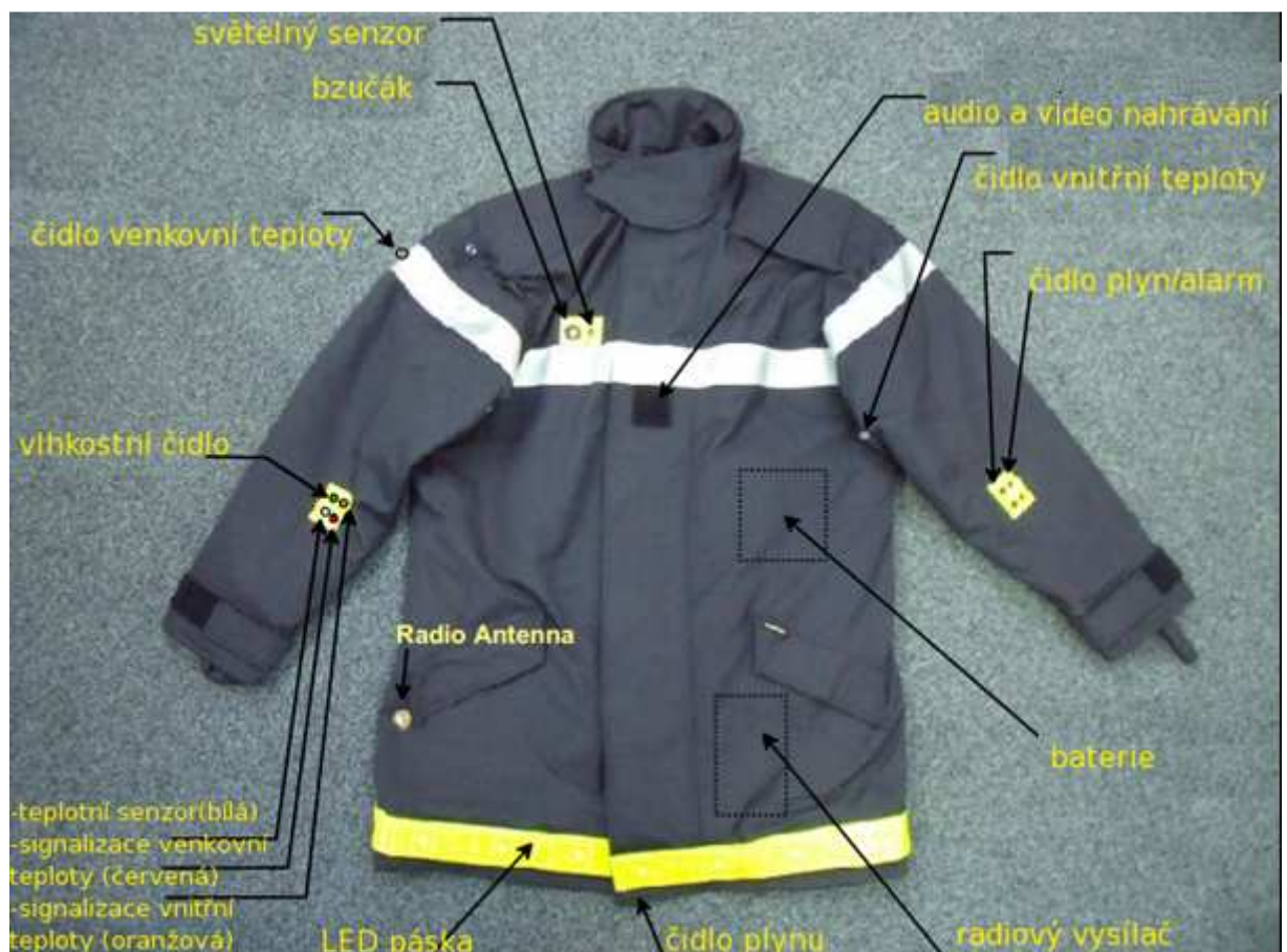
Obr.6.: Elektronicky vybavený oblek (převzato z:[8])
