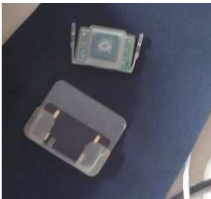
Obr.21. Vnitřní část pouzdra a pouzdro (nové upevnění)
