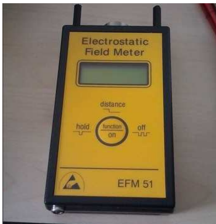
Obr.26. Měřicí přístroj pro měření indukovaného napětí
