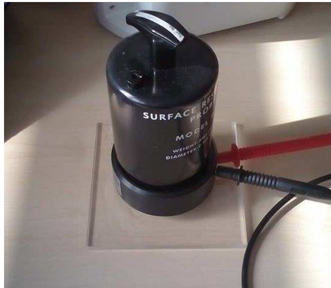
Obr.22. Izolační podložka, měřící elektroda a zátěž
