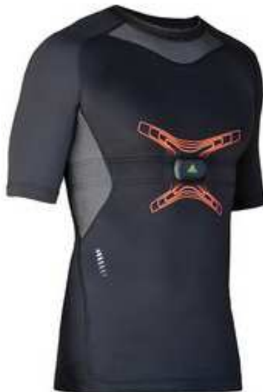
Obr.1. Běžecké triko od společnosti Textronics (převzato z:[4])
