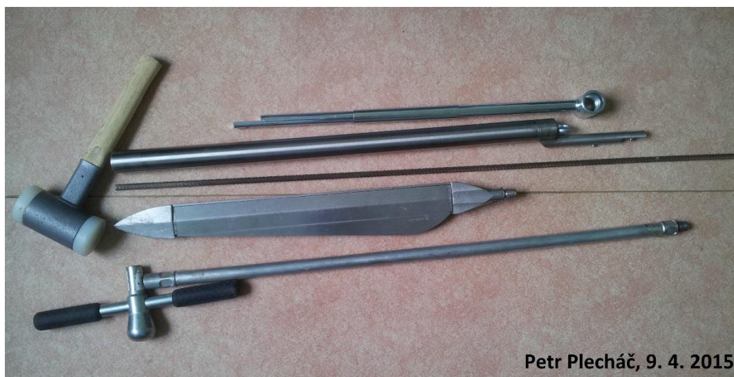
Obr. 8: Použité nářadí při odběru sedimentů (komorový a pístový vzorkovač, kladivo a kovová tyč)
