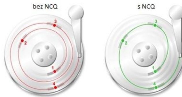
Obr. č. 41: Operace (čtení/zápis) HDD bez NCQ, s NCQ (zdroj: http://zive.v.mfstatic.cz/GetThumbNail.aspx?id_file=468371787&width=400&height=500&q=100 )
