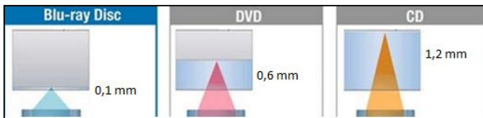
Obr. č. 32: Zaostřování laserového paprsku na BD, DVD a CD (zdroj: http://www.zive.cz/clanky/blu-ray-posledni-vykrik-optickych-medii/sc-3-a-153922/default.aspx )
