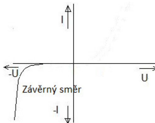
Obrázek 16 - Dioda v závěrném směru
