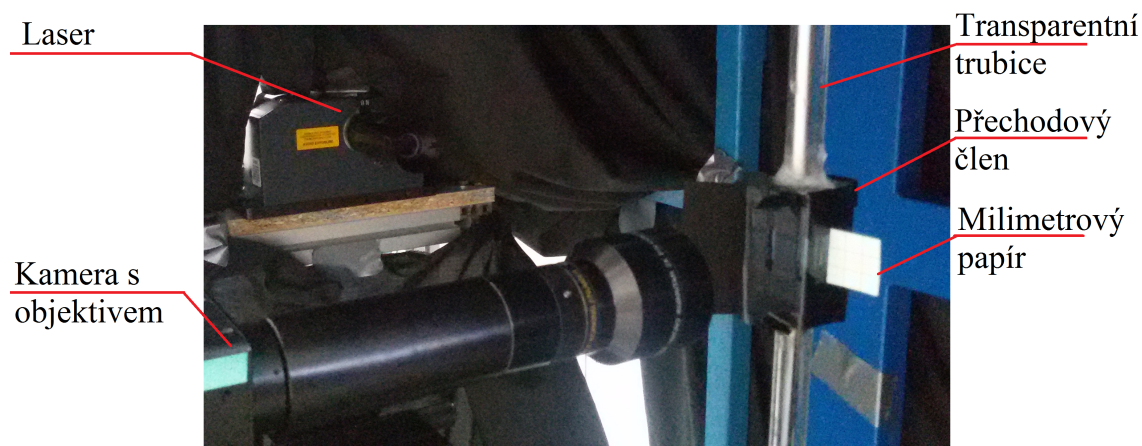
Obrázek 11: Ustavení kamery a laseru
