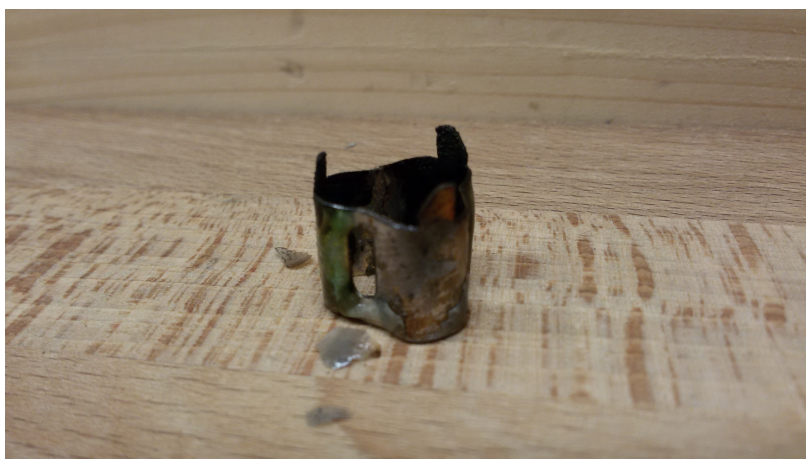
Obrázek 8: Distanční mřížka s mísíci lopatkami po pájení
