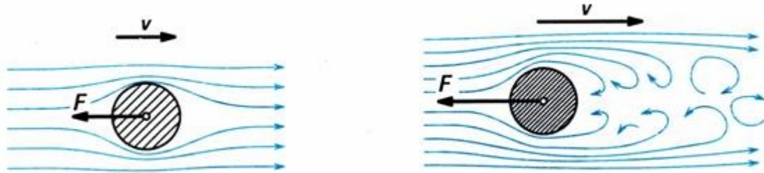
Obr. 2 Laminární proudění (vlevo), turbulentní proudění (vpravo) [22]
