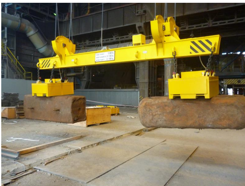
Obr. 16 - Přeprava materiálu pomocí břemenových elektromagnetů [12]
