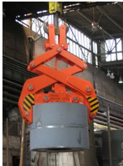
Obr. 19 - Samosvorné kleště držící břemeno [16]
