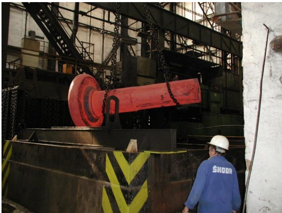
Obr. 15 - Manipulace břemene za pomoci řetězu [11]
