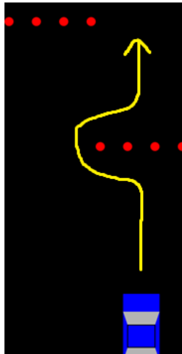
Obr. 8.2 Rozestavení dráhy při klasickém Losim testu [9]
